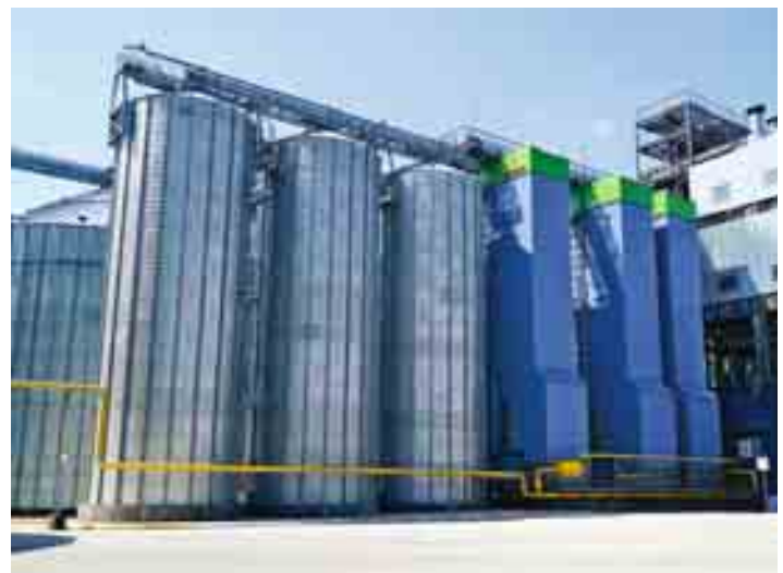
Кожна сушарка LAW складається з трьох шахт
